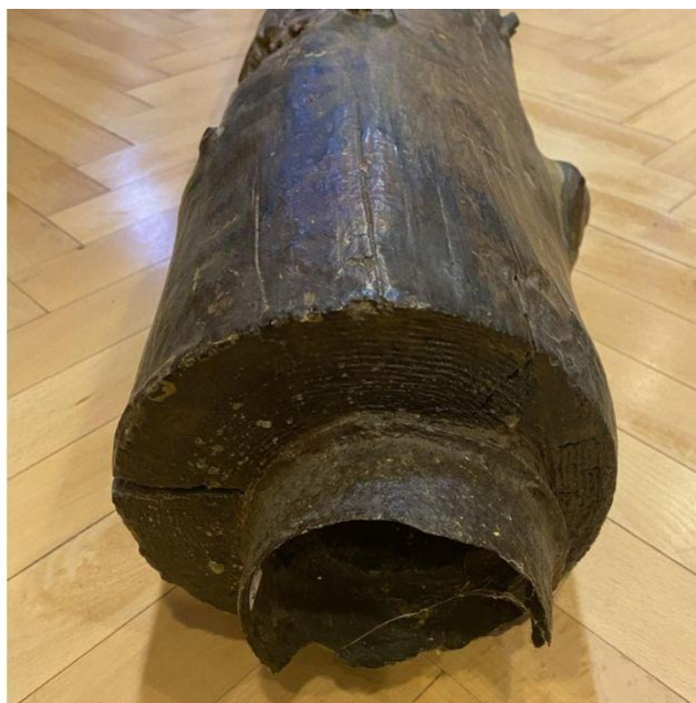
drevené vodovodné potrubie
